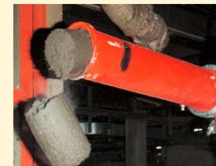
Fanghi da filtropressa e centrifuga
